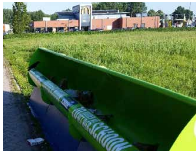
[112] De vorm van deze afvalbak is afgestemd op de automobilisten die hun afval via het raam uit de auto willen gooien.
