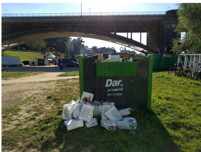
Afbeelding 20. De container bij de Ooijpoort, met de tasjes die uit de opening steken. Wanneer tasjes klem zitten in de opening, lijkt de container vol en lokt zo bijplaatsingen uit.
