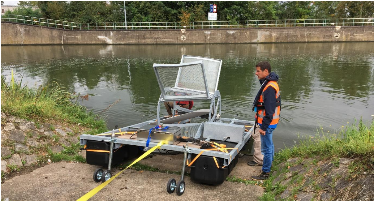
Figuur 3-1 impressie van systeem dat via trailerhelling in het water rolt
