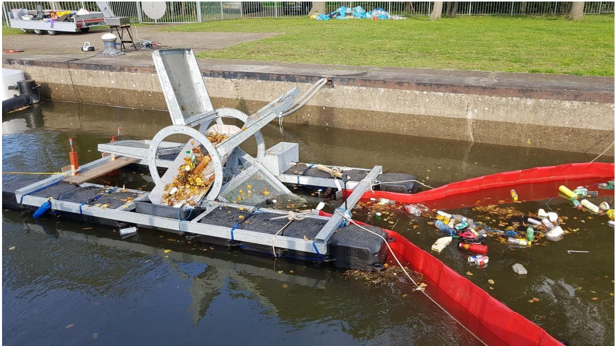
Figuur 3-9 Systeem van Noria met plastic afval in het water.
