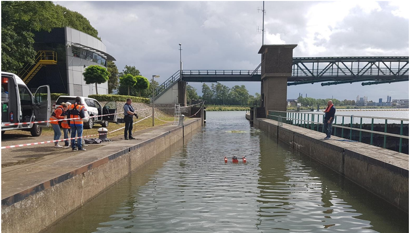
Figuur 2-4 Kalibratiemetingen van de stroomsnelheid
