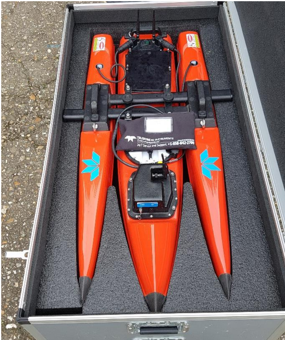
Figuur 2-3 Foto van de apparatuur welke tijdens de test is gebruikt om stromingsprofiel in kaart te brengen. Teledyne riverboat 1200 Hz, Rio Grande Workhorse
