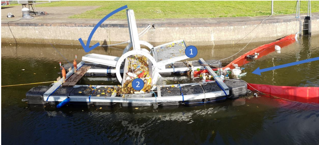
Figuur 3-7 Werking van het systeem van Noria. Met hierin de draairichting van de scheppen. De stroomrichting van het water en het zwerfafval. En de scheppen (1) en de afvoer naar de opslagcontainer (2).
